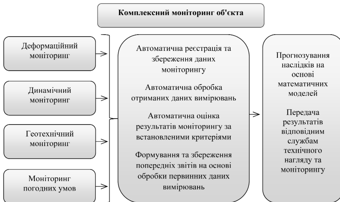
Рис 3. Структурна схема комплексного моніторингу
