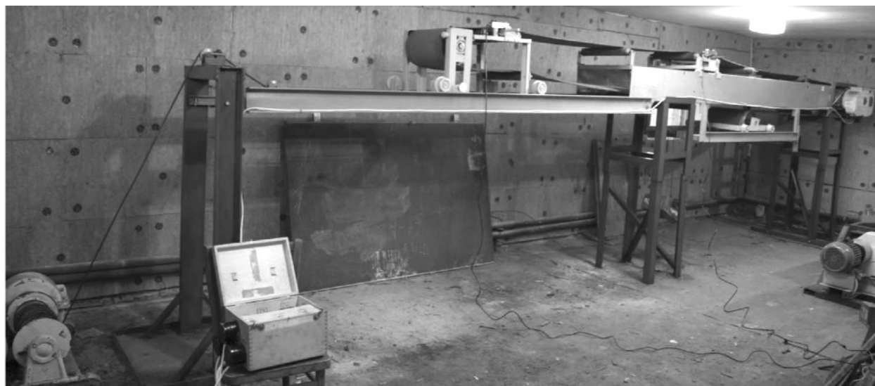
Рис. 3. Общий вид экспериментального конвейера для исследования нагруженности ленты возникающей во время изменения длины транспортирования
