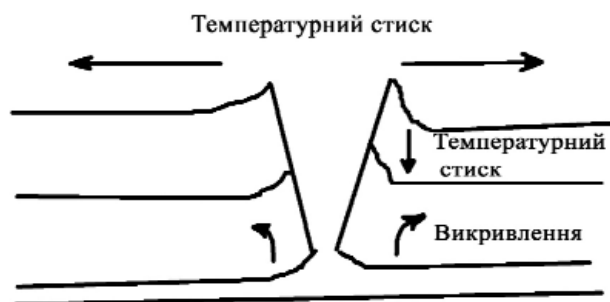
Рис. 5. Механізми тріщиноутворення під впливом температури
