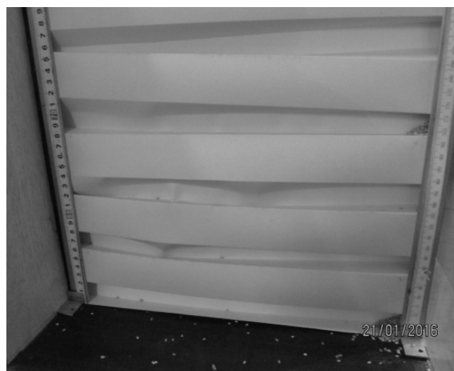
Рис. 4. Руйнування панелі внаслідок втрати місцевої стійкості нижніх пластин другого та третього гофрів знизу
