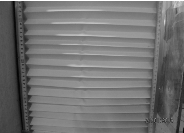
Рис. 5. Руйнування панелі внаслідок втрати місцевої стійкості пластин гофрів по всій висоті
