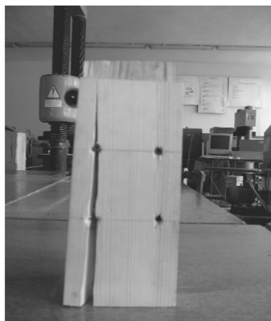
Рис.6. Клеєметалевий зразок після випробування
