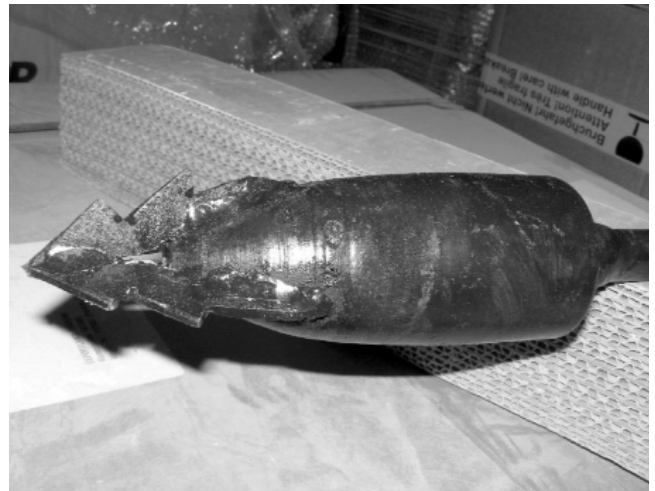
Рис. 13 Робоча насадка для руйнування пробки
