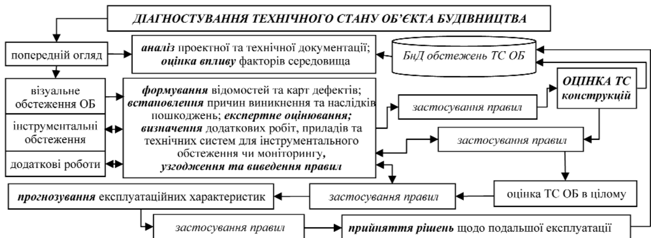
Рис. 1. Основні етапи діагностування технічного стану об'єктів будівництва
